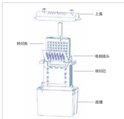
图2.1小型湿式转印槽结构图
